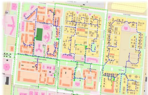
Рисунок 5 – Пример отображения трассировки газопроводов в населенном пункте
