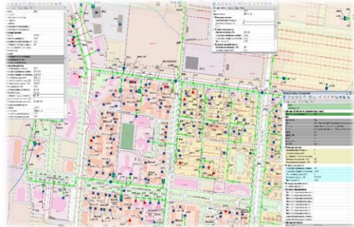
Рисунок 4 - Пример отражения базы данных элемента системы газоснабжения
